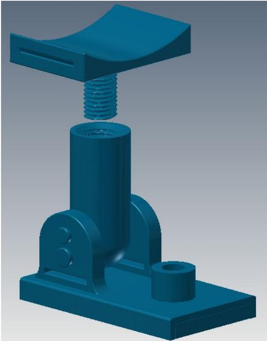
**Paso 4:** Enrosque verticalmente el apoyo de brazo (3) dentro del pilar ajustable (2). El hilo entre estas dos piezas permite ajustar la altura a comodidad del paciente. Al realizar esto cuide no enroscar hasta el máximo la pieza pues corre el riesgo de romperse. La pieza (3) posee rendijas que permiten el paso de velcro para sostener el brazo en la posición correcta.
