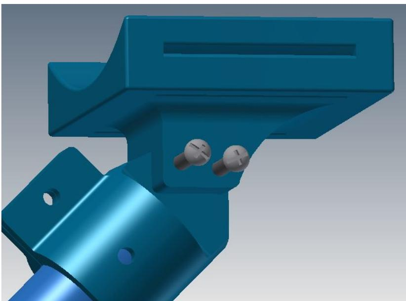
**Paso 9:** Se ajusta la posición del apoyo de antebrazo (8) en el segundo enlace (5) mediante los pernos (14) y tuercas (15). Verifique que la altura a la cual queda el apoyo de antebrazo sea la correcta, respecto a su posición deseada y respecto al apoyo de brazo. De ser necesario utilice un PVC de distinto largo. La pieza (8) posee rendijas por donde se puede pasar velcro
