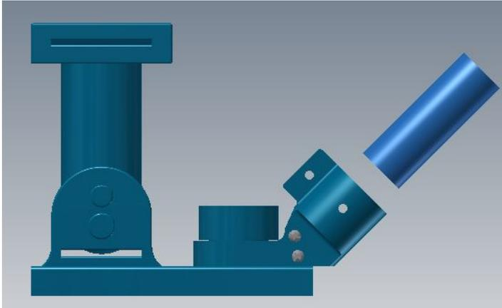
**Paso 7:** Coloque el tubo de PVC (7) dentro del enlace (5) recién instalado. El largo del tubo de PVC fijará la altura del apoyo de antebrazo. Para dejar ambos apoyos a la misma altura, el PVC debe tener un largo mínimo de 71mm. De ser necesario, para fijar en su posición al tubo (7) se puede utilizar la abrazadera de la pieza (5)
