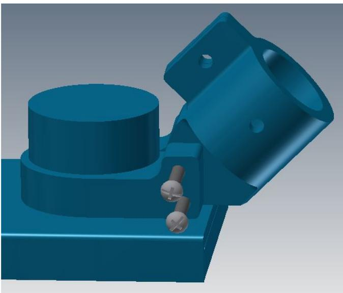
**Paso 6:** Utilice los pernos de  $\text{Ø}5/32''$  de 2'' (14) para fijar en su posición el primer enlace (5) a la argolla (4). Utilice además las tuercas  $\text{Ø}5/32''$  (15) para fijar en su posición a los pernos.
