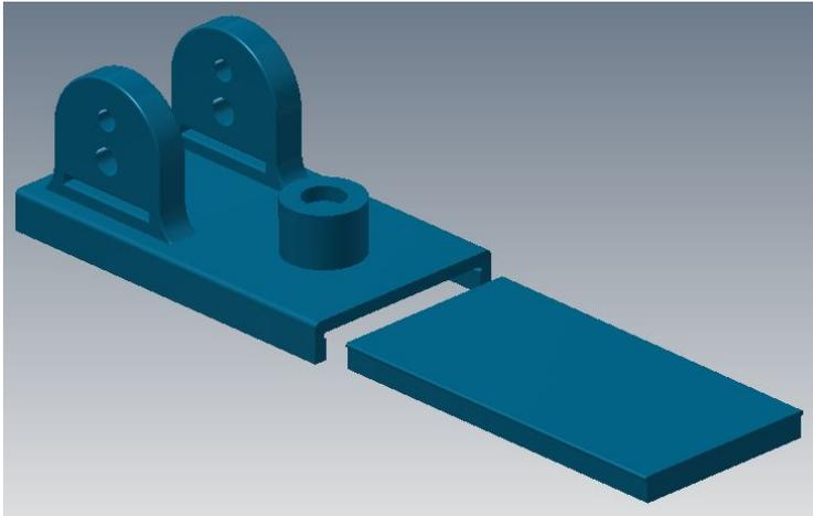
**Paso 1:** Insertar la sobrecarga (6) en la base (1). Previamente la base puede ser ajustada al apoyo de la silla de rueda a la cual equipar el dispositivo. De lo contrario, la pieza (6) posee espacio para pasar una guía que puede consistir en velcro.
